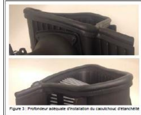
Figure 2 : Installation du caoutchouc d'étanchéité et mise en place effectuée
