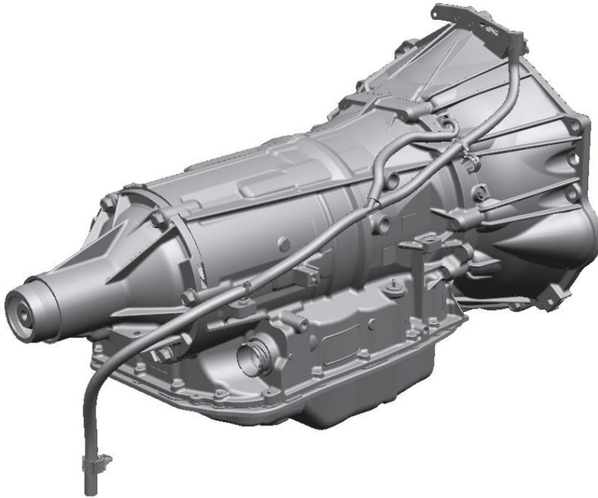
Conecte el extremo abierto corto sobre el tubo de ventilación en la transmisión. El ensamble de ventilación se debe montar tan alto como sea posible. El soporte incluido se puede montar a la parte superior de la transmisión al perno de conexión del motor para facilitar el montaje de la ventilación. El extremo abierto largo del ensamble del tubo de ventilación se debe enrutar lejos de cualquier fuente de calor o parte giratoria.
