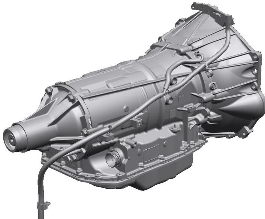
Raccorder la courte extrémité ouverte au tube d'évent sur la boîte de vitesses. La tuyauterie d'évent doit être montée aussi haut que possible. Le support fourni peut être monté sur le haut de la boîte de vitesses, sur le boulon de fixation du moteur, afin de faciliter le montage de l'évent. La longue extrémité ouverte de la tuyauterie d'évent doit être acheminée à l'écart de toute source de chaleur ou pièce en rotation.
