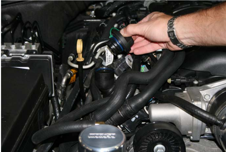
Step 27: Remove oil fill cap
