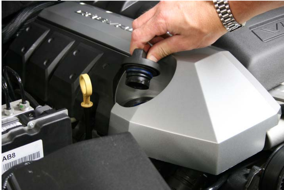
Step 1: Remove oil fill cap
