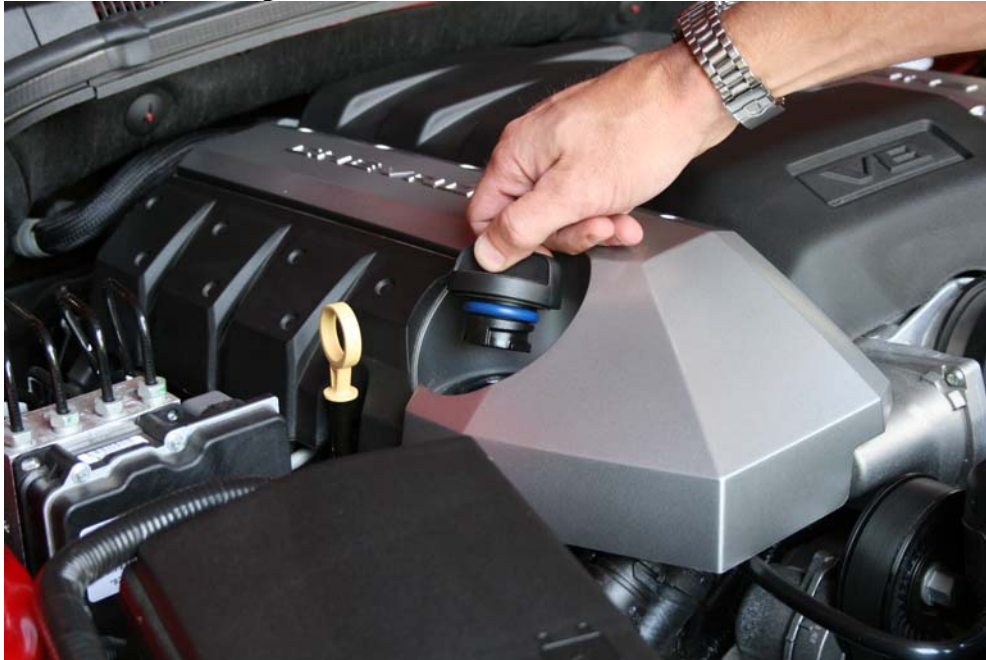
Step 1: Remove oil fill cap
