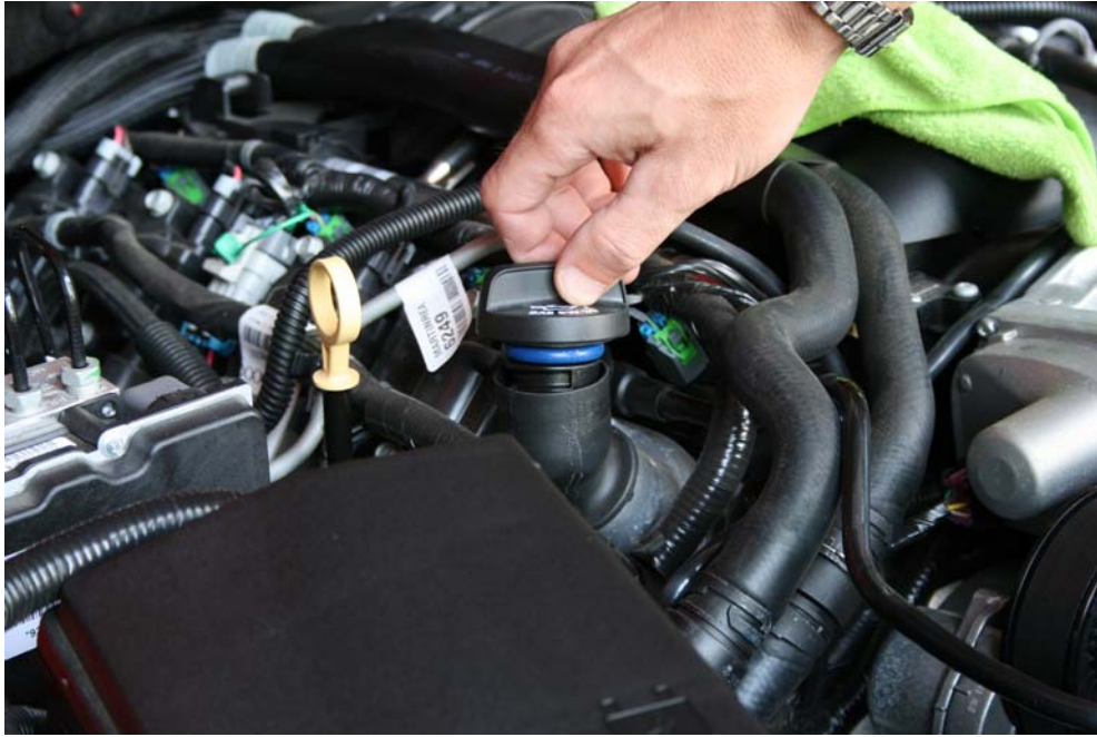
Step 3: Replace oil fill cap
