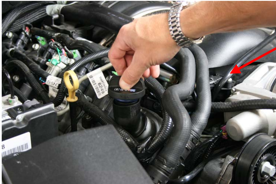
Step 3: Replace oil fill cap
