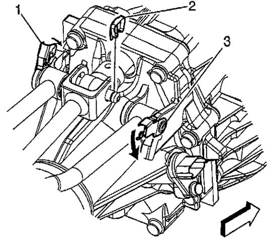
Utiliser un outil à lame plate pour dégager le dispositif de retenue de la goupille de tige de commande de changement de vitesse central (2). (Voir ci-dessus).
