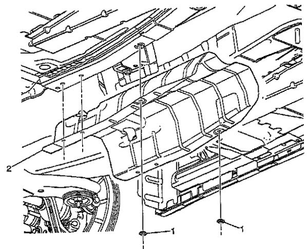
Déposer les boulons (2) du support central d'arbre d'entraînement et abaisser le centre de l'arbre d'entraînement.
